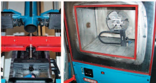
die Produkte an der CAD-Anlage entwickelt und schon theoretisch auf Herz und Niere geprüft. Später im Labor unterliegen die Produkte Prüfungen wie Zug-, Schlag-, Säge- und Kneiftest, letzterer zur Simulation des Widerstandes gegen Bolzenschneider. Sie werden stark erhitzt und gekühlt, um auch mögliche Reaktionen auf Wärmeveränderungen festzustellen. Da trennt sich schnell die Spreu vom Weizen.
